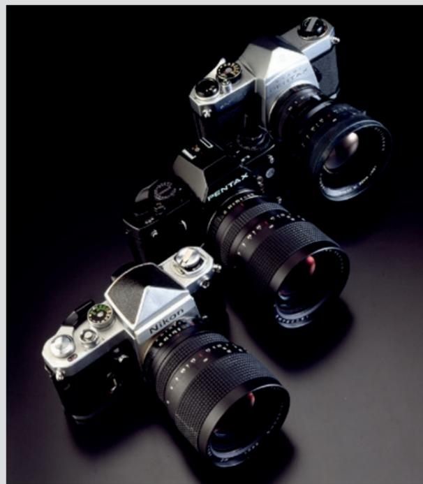
Obiettivi Isco Iscorama per reflex 35mm. Qui in illustrazione, in innesto a baionetta Nikon e Pentax, e in innesto a vite 42x1. Producono immagini riferibili alla focale 50mm, in verticale, e alla focale 28mm, in orizzontale. Anamorforesi da compensare in proiezione o riproduzione litografica.
